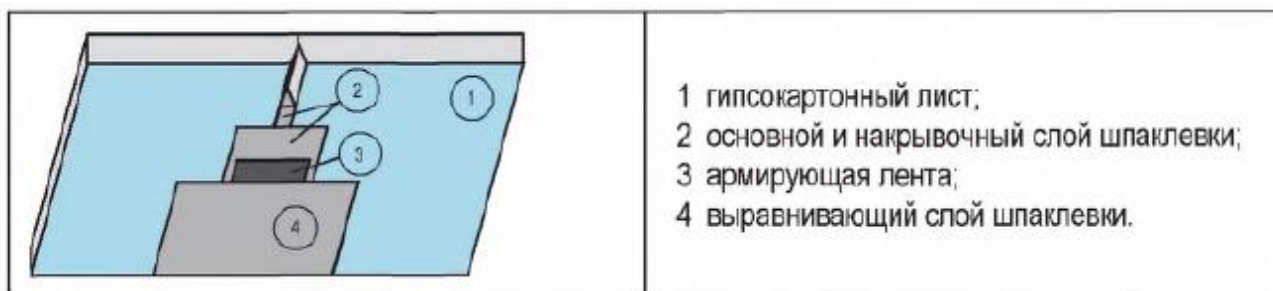
Рисунок 28 – Обработка стыка гипсокартонного листа, образованного обрезанными кромками гипсокартонного листа со снятой фаской под 22,5° на 2/3 толщины листа
