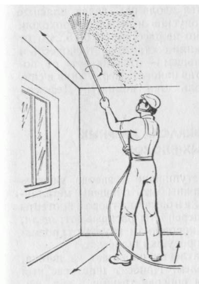
Рисунок 71 — Окраска поверхности потолка
