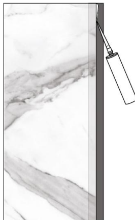
Нанесение клея на металлическую пластину
