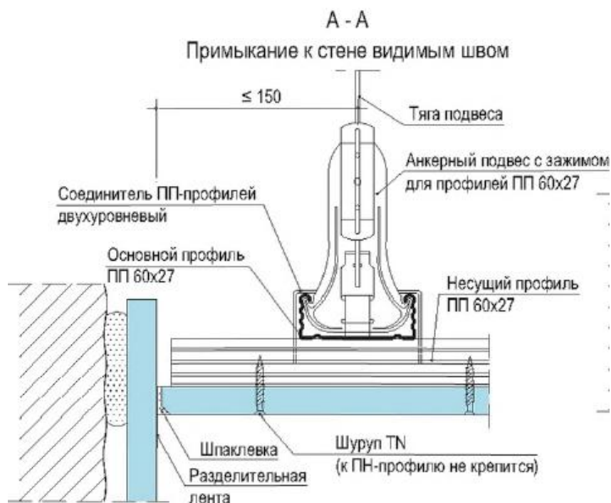
Рисунок 60 – Потолок П112 (П212) системы КНАУФ
