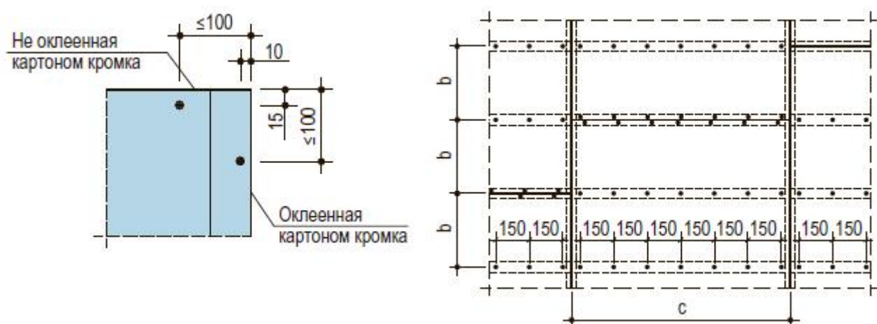
Рисунок 64 – Схема крепления шурупами
